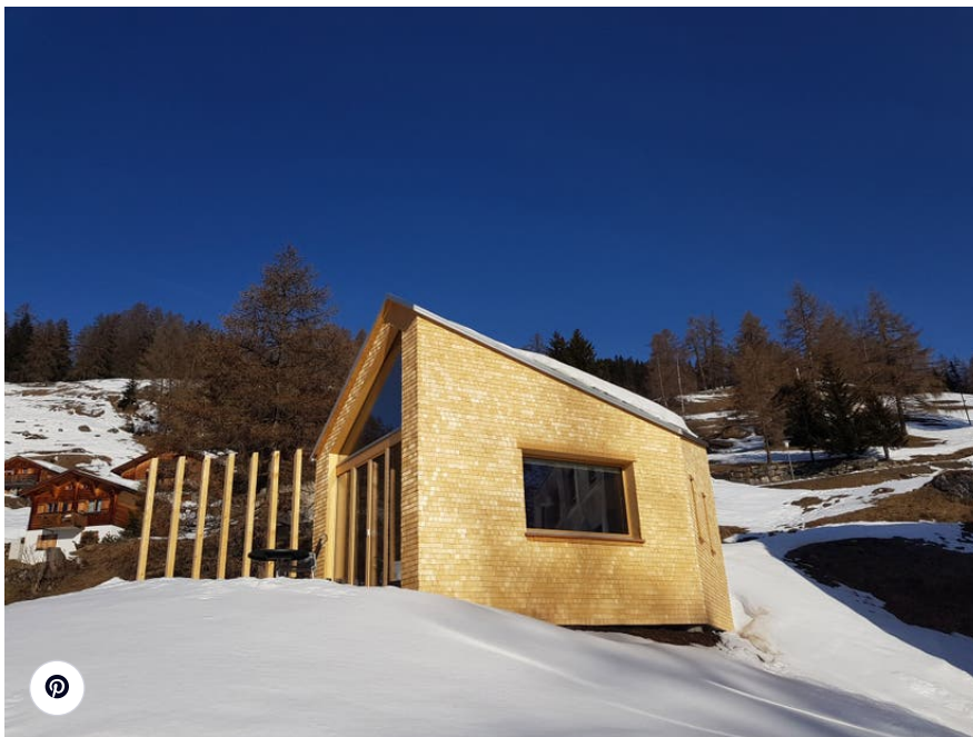
Das Tiny House ist mit Schafwolle aus der Alpenregion isoliert. (Bild: Kim Dang)
